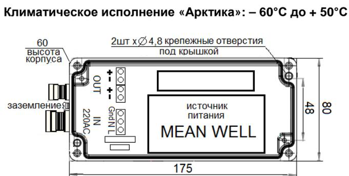
Кабельный ввод под сетевой кабель Ø 10,0мм max
