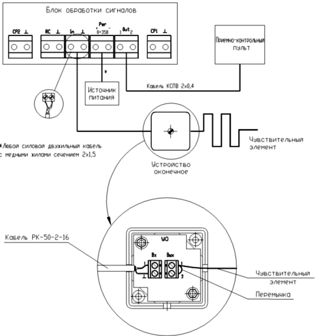
Данный вариант обеспечивает контроль целостности только линии подключения чувствительного элемента и не обеспечивает контроль целостности самого чувствительного элемента.
