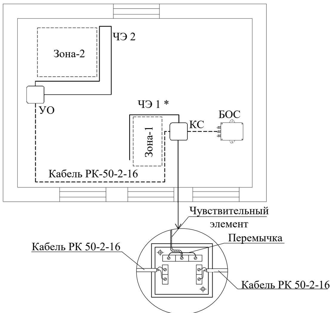
БОС – блок обработки сигналов извещателя «Гюрза-027ПЗ»
