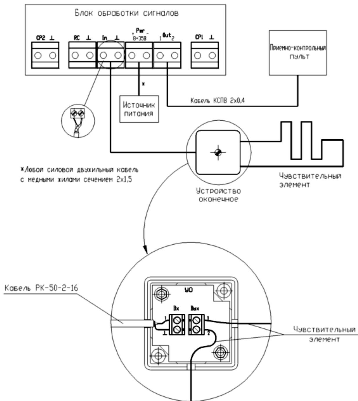
Рисунок А.7.1 – Вариант с замкнутым чувствительным элементом
