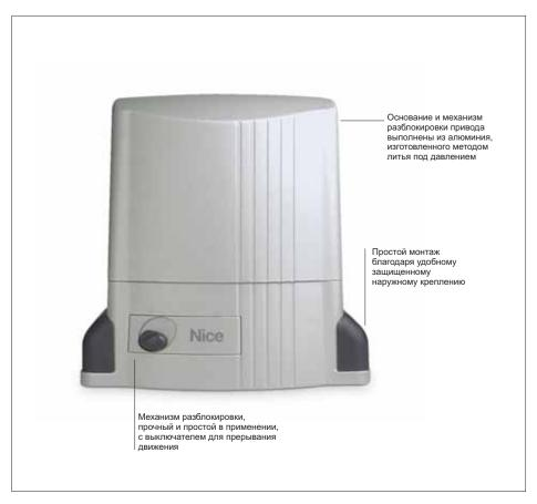
Электромеханический привод для автоматизации откатных ворот весом до 1500 кг.
