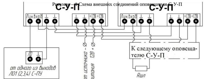
Rшп – резистор типа С1-4, 0,25Вт ЭКМ ±5%, устанавливается в конце шлейфа (идёт в комплекте поставки с прибором С-ПУ).
