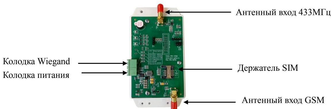
Корпус считывателя предусматривает варианты крепления под винт или на DIN рейку. Максимальная длина кабеля UTP 5 кат. для подключения считывателя к контроллеру СКУД — до 50 метров.
