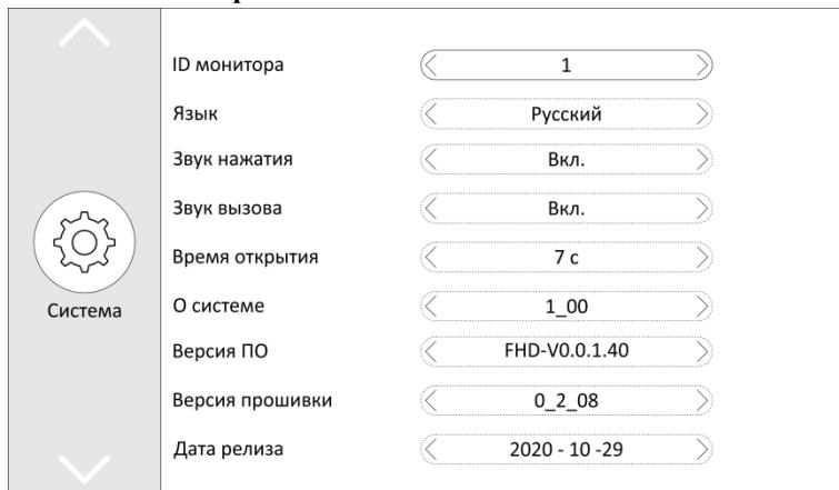
**[ID монитора]** означает идентификатор внутреннего устройства, диапазон от 1 до 6. 1 означает, что монитор является основным, 2-6 означает, что внутренние мониторы являются дополнительными. Для одной системы максимум до 6 мониторов.
