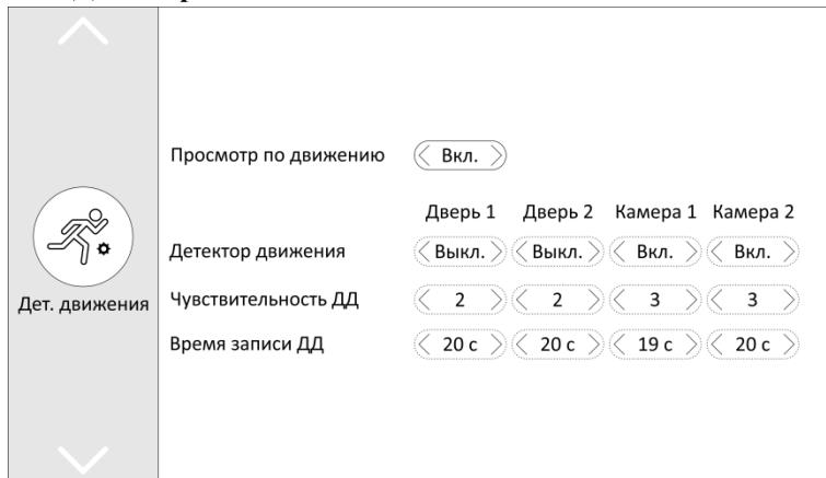
Раздел детектора движения позволяет настроить любой из четырех каналов на включение записи и мониторинга по обнаружению движения перед вызывной панелью или камерой.
