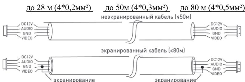
В случае использования неэкранированного кабеля длина линии не должна превышать 50м. При использовании экранированного кабеля длина линии может быть увеличена до 80м.
