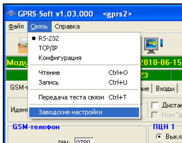
Рис. 13. Функция „Заводские настройки” в меню „Связь”.
