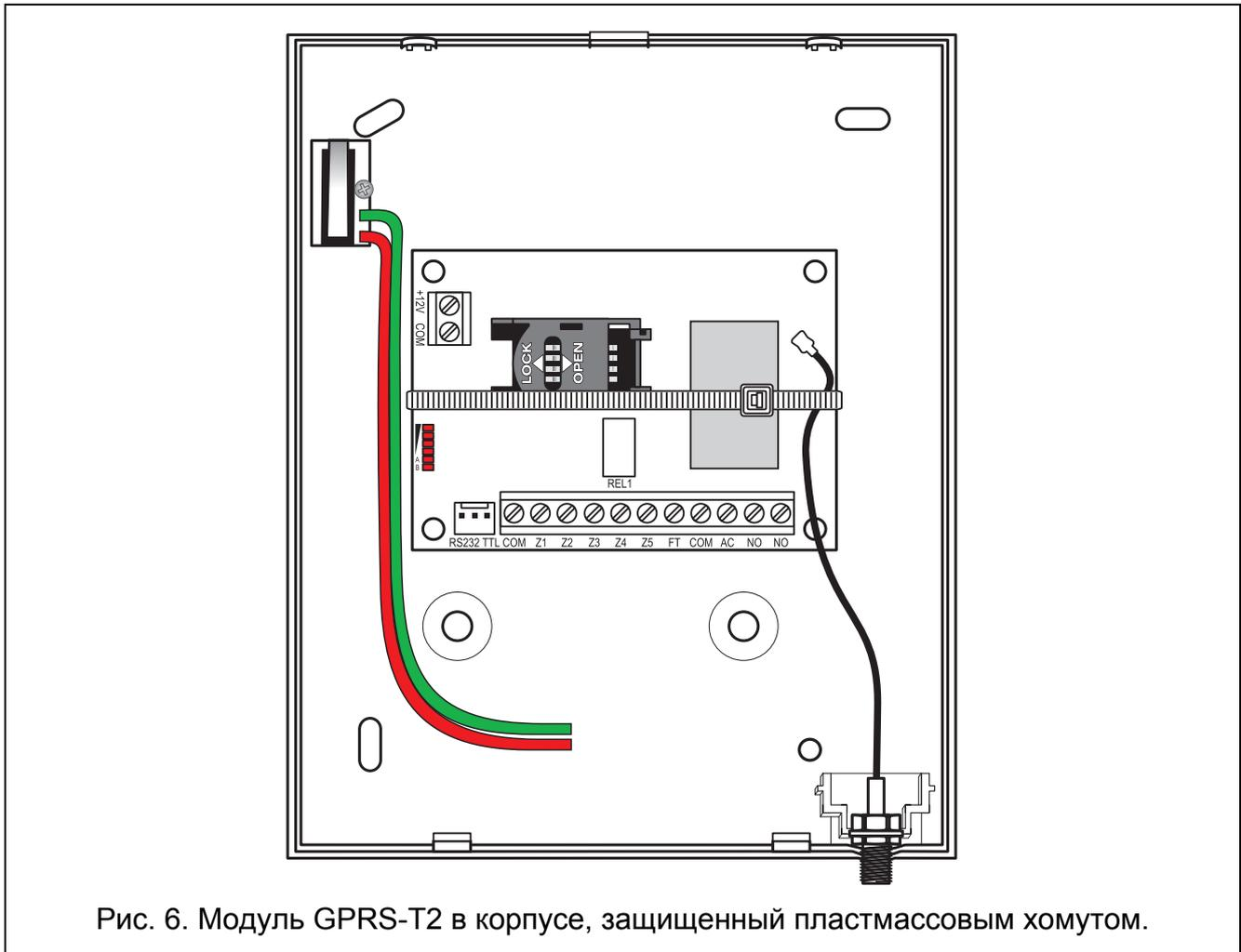
Рис. 6. Модуль GPRS-T2 в корпусе, защищенный пластмассовым хомутом.
