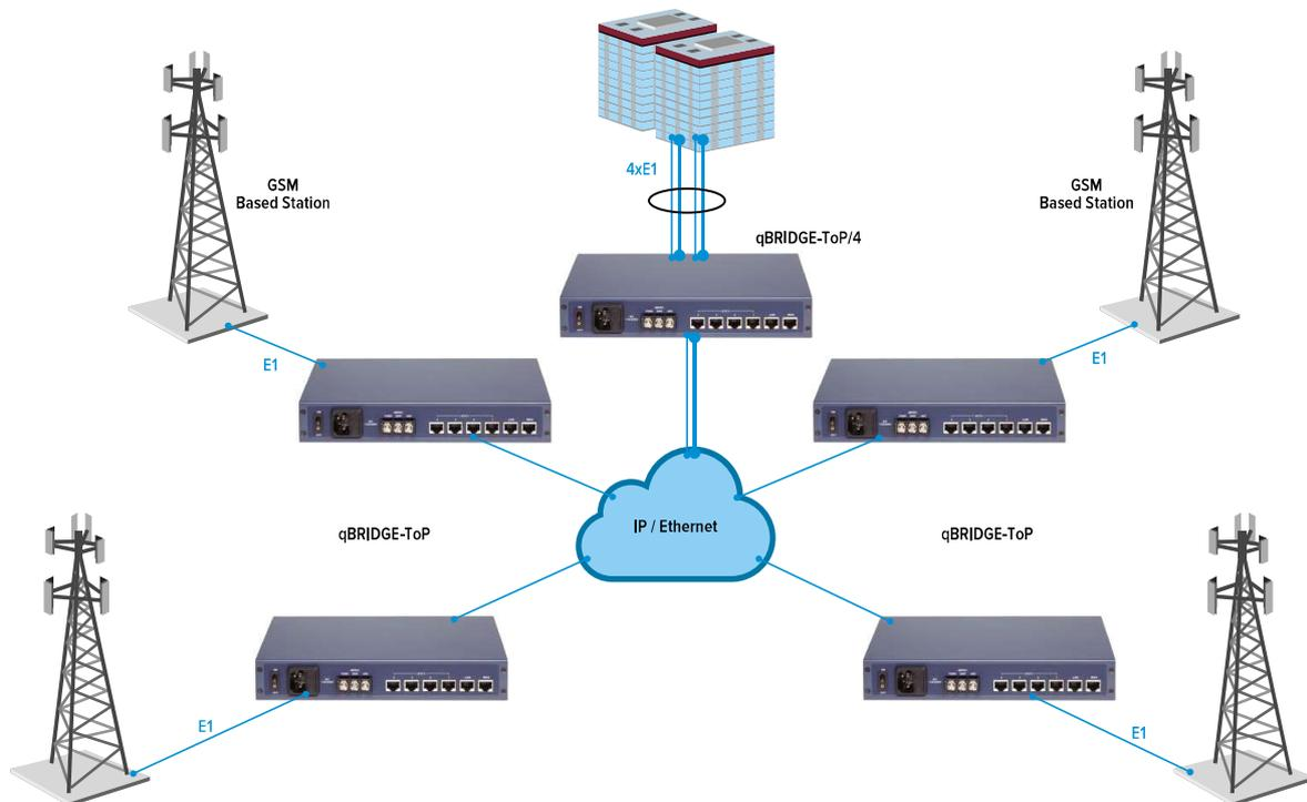
Устройства могут использоваться также для подключения базовых станций сотовой связи к контроллеру и создания удаленных абонентских узлов доступа к центральному узлу сети оператора с предоставлением интегрированных услуг по передаче голоса и данных.
