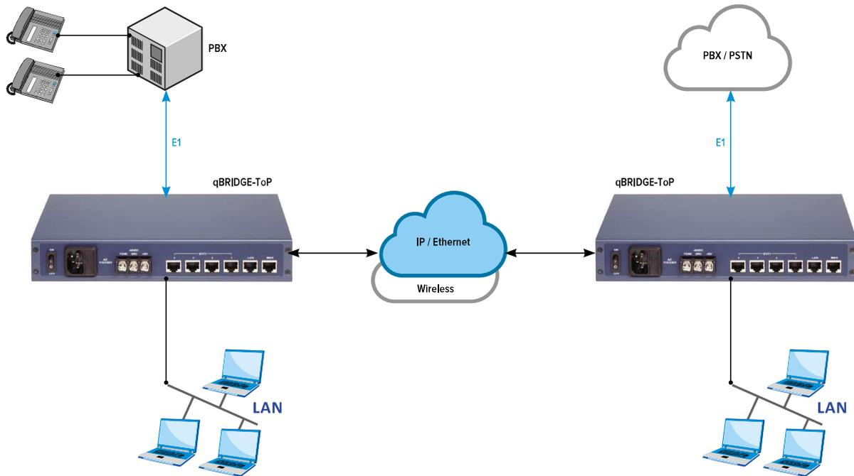
Уникальные технические параметры устройства, в том числе оригинальный алгоритм восстановления синхронизации, обеспечивают необходимое качество услуг, высокую производительность и надежность. Важным достоинством устройства является устойчивая работа через линии радио-Ethernet и беспроводные IP-сети (Wi-Fi Wireless LAN).
