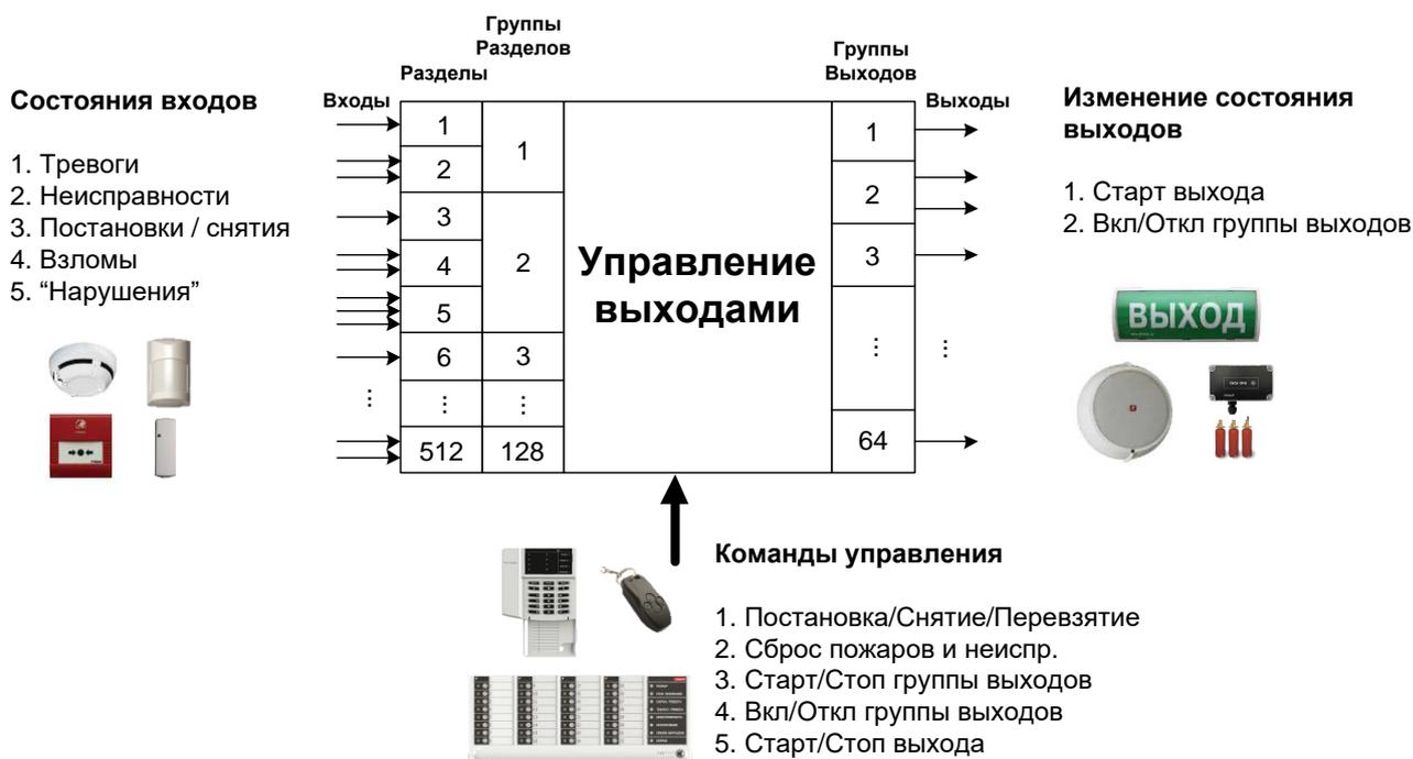
Рисунок 32 Принцип управления выходами
