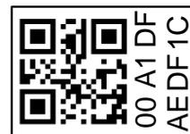
Адрес NID нанесён на ярлыке на поверхности модуля сетевого интерфейса. Адрес передаётся устройством в линию связи при нажатии на кнопку «Service», встроенной в каждое устройство ИСБ.
