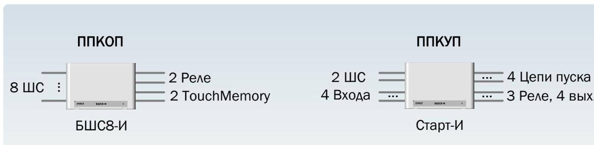
Рисунок 17 Виды приёмно-контрольных устройств S2
