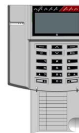
При программировании каждого устройства **индикации** конфигурируется связь встроенных индикаторов с индицируемыми элементами. Каждый индикатор способен индицировать состояние произвольных **разделов, групп разделов, входов** или **выходов** сегмента.
