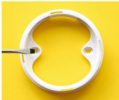
— Установите на место крышку батарейного отсека, совместите извещатель с основанием и закрепите, повернув по часовой стрелке.
