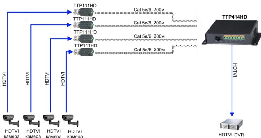
Рис. 4 Схема подключения приемопередатчика TTP414HD и приемопередатчиков TTP111HD для работы с HDTVI-видеокамерами
