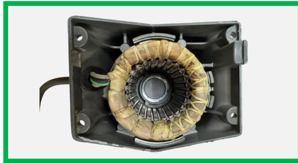
Статор с медной обмоткой
