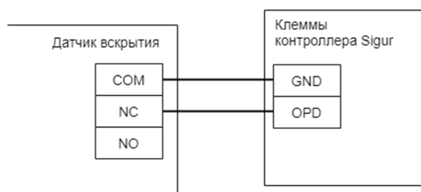
Подключение датчика вскрытия корпуса к контроллеру.
