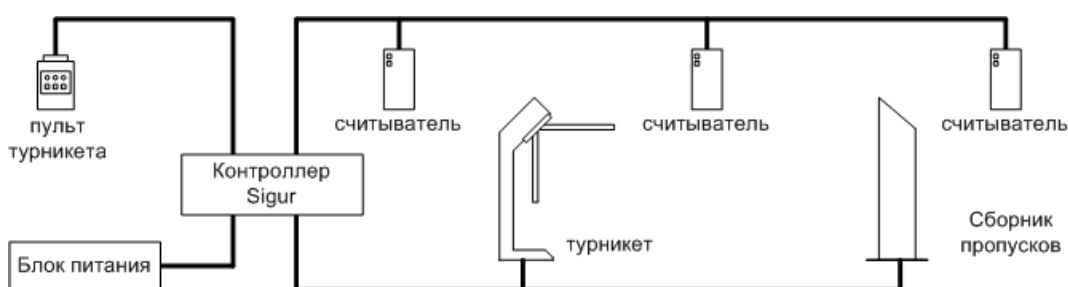
Пример подключения турникета с картоприёмником.
