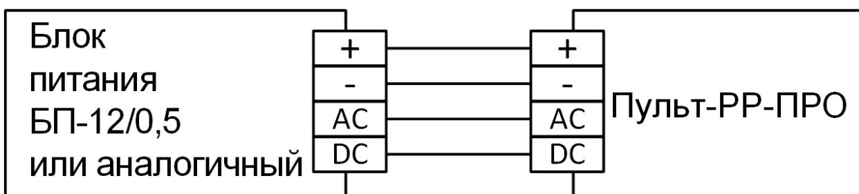
При необходимости обеспечения двух вводов питания допускается включение двух внешних блоков питания по следующей схеме:
