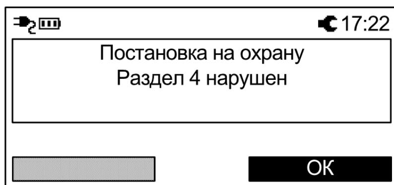
При постановке на охрану с обходом (отключением) на экране отобразится сообщение с номером и описанием отключеного извещателя (шлейфа) и в верхней части экрана будет индицироваться пиктограмма .
