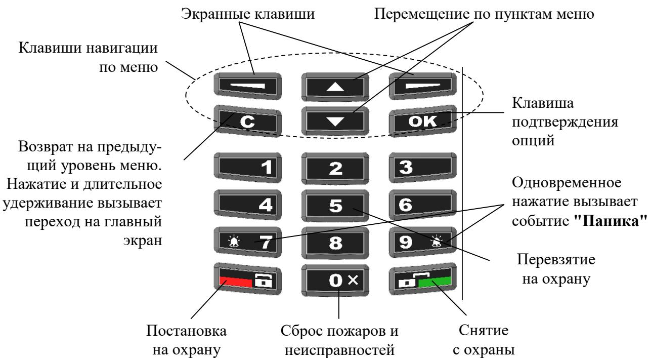
Специализированные клавиши  $\leftarrow\text{lock}$  (взять) и  $\rightarrow\text{unlock}$  (снять) предназначены для постановки на охрану и снятия с охраны соответственно. С помощью клавиши  $\text{0 } \times$  выполняется сброс пожарных тревог и неисправностей. С помощью клавиши  $\text{5}$  выполняется "Перевзятие" разделов на охрану.
