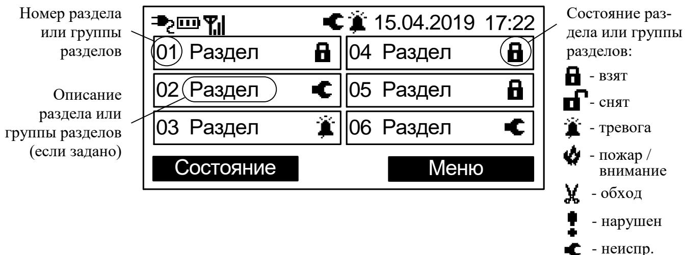
Экранные клавиши на главном экране имеют обозначения **«Меню»** и **«Состояние»**. При нажатии экранной клавиши **«Меню»** отображается меню пульта.
