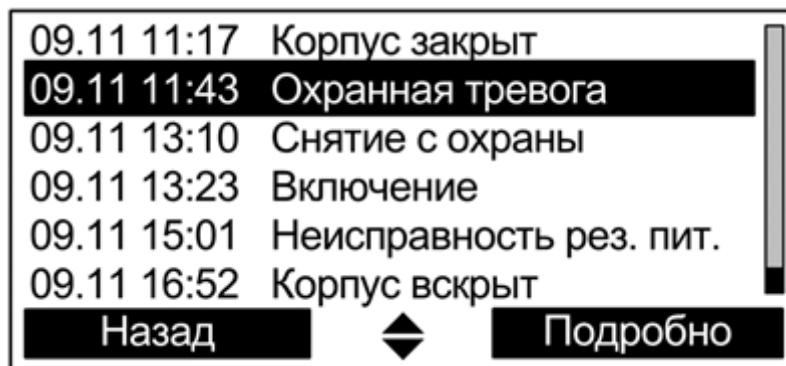
При нажатии экранной клавиши **«Подробно»** открывается окно с детальным описанием события, включающим дату, время и место события, а также дополнительную информацию в зависимости от типа события. Номера раздела и устройства сопровождаются текстовыми описаниями (при наличии).
