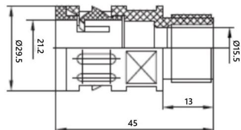
Рис.1. Габаритные и присоединительные размеры
