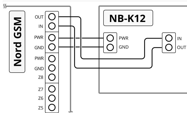
К охранным приборам Норд GSM 5.x подключаются максимум 3 клавиатуры. К приборам Nord GSM/WRL подключаются до 5 клавиатур.
