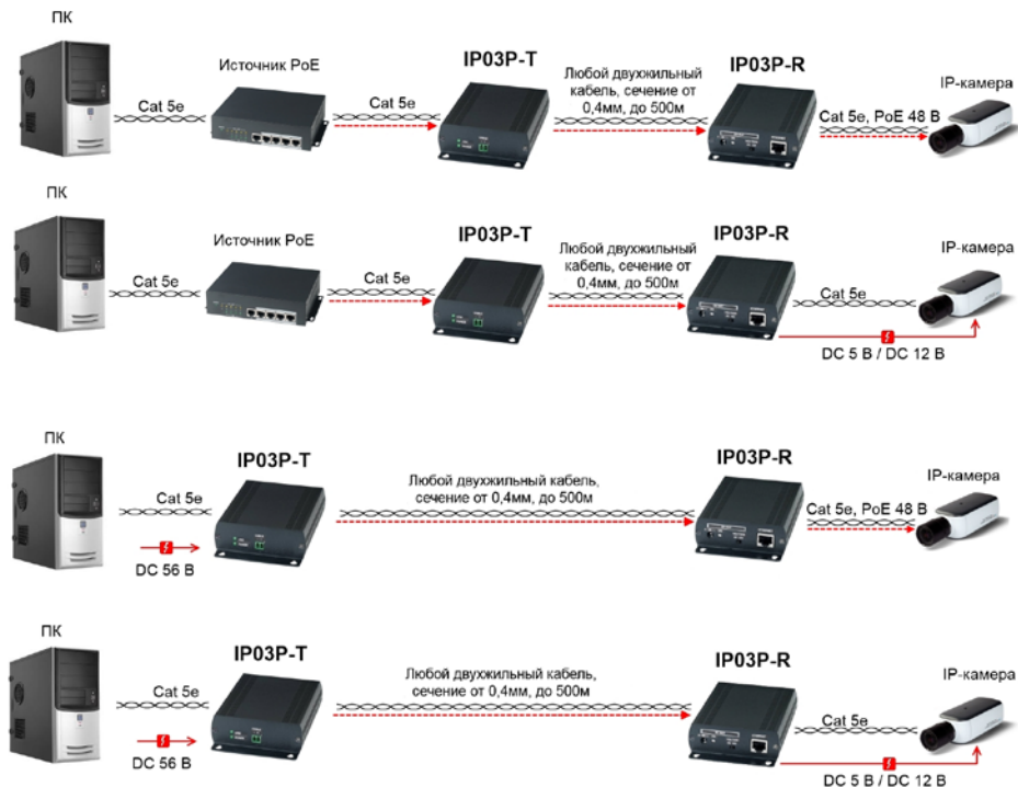
Рис.5 Схемы подключения передатчика IP03P-T и приёмника IP03P-R.
