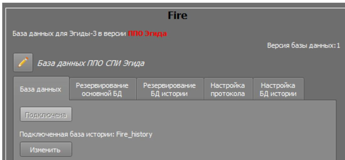
**Рисунок 5.33. Первая вкладка конфигуратора БД – «База данных»**
