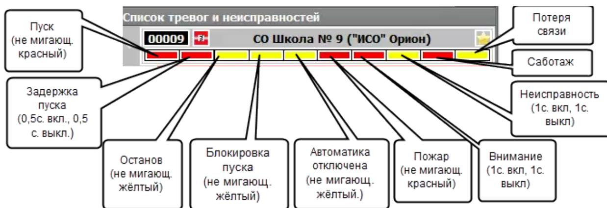
**Рисунок 5.12. Описание режимов индикации панели индикации списка тревог**
