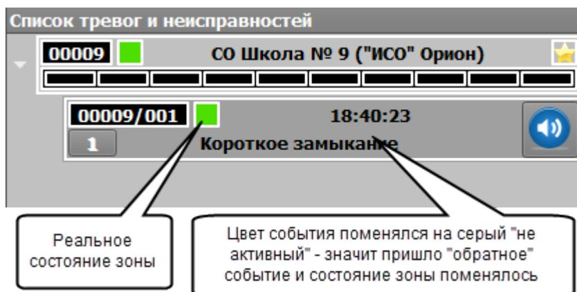
**Рисунок 5.11. Пример отображения события в списке тревог при восстановлении состояния зоны**
