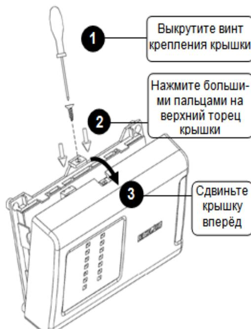
Рисунок 3.8. Снятие крышки «УО-4С»
