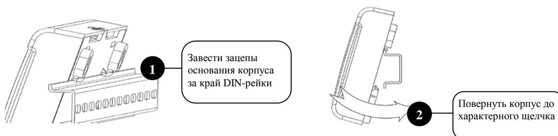
Рисунок 3.9. Монтаж ПОО «УО-4С» на DIN-рейку
