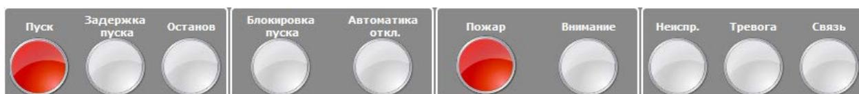
Красным мигающим индикатором отображаются объекты, находящиеся в состоянии задержки автоматического пуска или речевого оповещения, останова задержки (паузы) пуска. После окончания задержки или сброса задержки пуска противопожарной защиты, индикатор гаснет.
