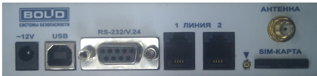
Рисунок 3.5. Задняя крышка «УОП-3 GSM» с разъемами
