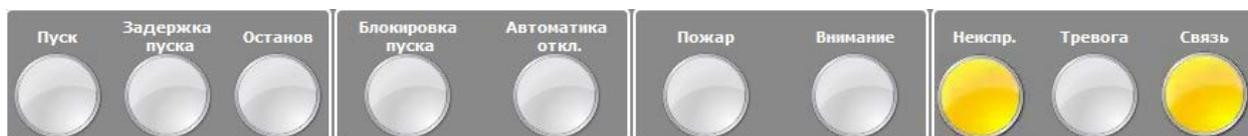
Неисправность пожарного оборудования, задержка пуска АУП, задержка пуска речевого оповещения, неудачный пуск АУП, ошибка в ответе, отказ СДУ, короткое замыкание, обрыв, неисправность термометра, ручной тест – мигающий жёлтый с частотой 0,5 Гц (1 раз в 2 секунды).
