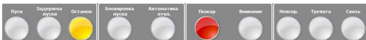
Состояние отключения автоматики или блокировки пуска отображаются немигающим индикатором желтого цвета.
