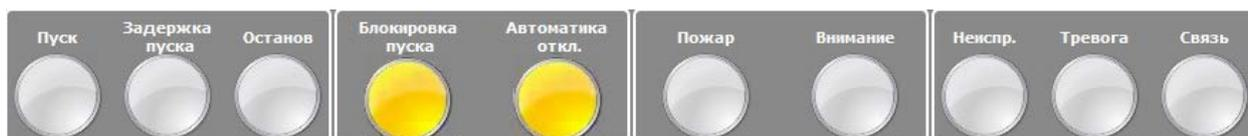
Задержка пуска ПТ и задержка пуска РО отображается мигающим индикатором красного цвета, при паузе (останове задержки пуска ПТ) индикатор горит постоянно до сброса (останова) задержки пуска ПТ или РО.
