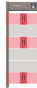
Индикация красного цвета – тревога, отображает детектирование металлодержателя предмета, соответствующего установленной программе и параметрам чувствительности прибора
