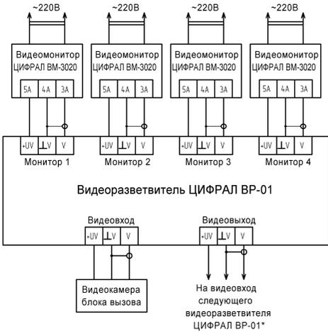
\* На последнем видеоразветвителе между клеммами «V» и «LV» установить согласующую нагрузку - резистор 75 Ом.
