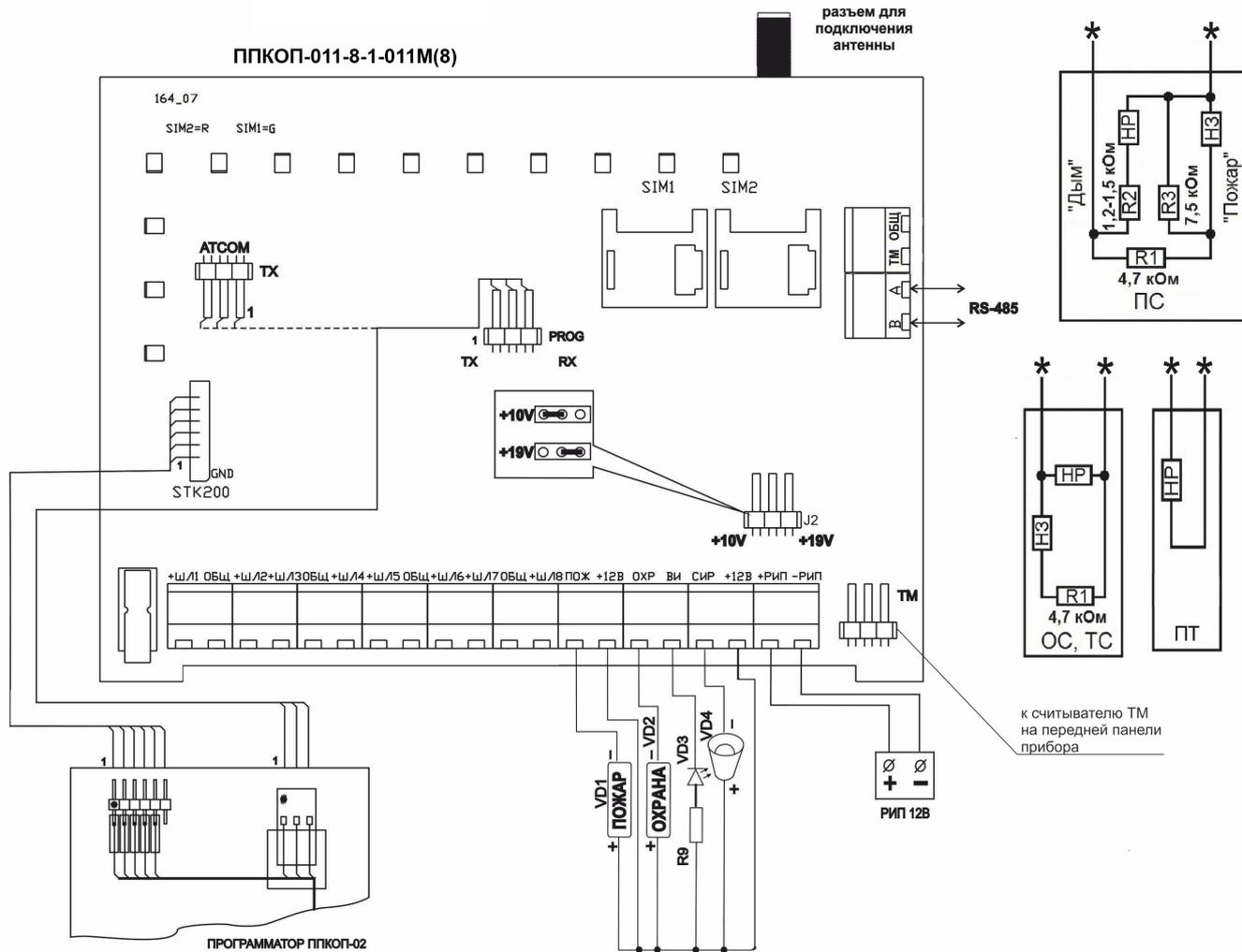
Рисунок 2. Схема подключения прибора
