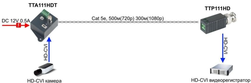
Рис.3 Подключение TTA111HDT
