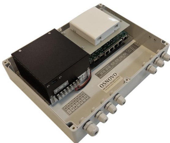
Рис.2 Уличный коммутатор SW-80402-WL(port 90W), вид внутри.
