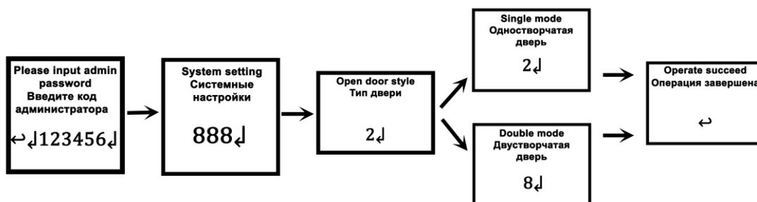
**8↵ Back time open mode (режим свободного входа, режим N-лиц).** Этот режим предназначен для ситуаций, в которых замок должен открываться свободно с помощью любого кода или карты, в случаях, когда ожидается большой поток людей или в местах с очень высокой проходимостью. Режим активируется кнопкой 2↵ и выключается кнопкой 8↵. После подтверждения выйдите из меню кнопкой ↵
