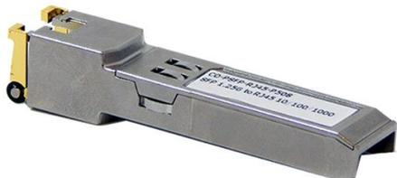
**CO-PSFP-RJ45-P508** -Модуль преобразования SFP слота в RJ45 разъем, дальность передачи до 100м, скорость передачи данных 1Гбит/с, Кабель UTP категории 5е и 6, температурный диапазон -0°С ~ +70°С, питание 3.3В, поддержка DDM.
