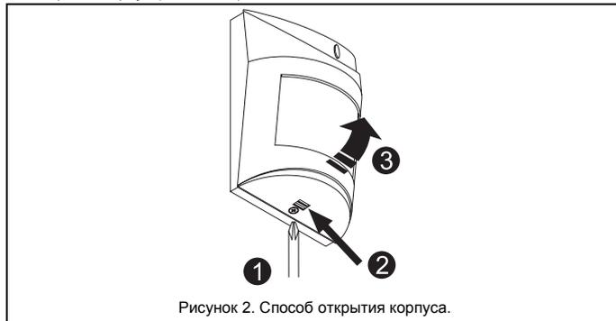
Рисунок 2. Способ открытия корпуса.
