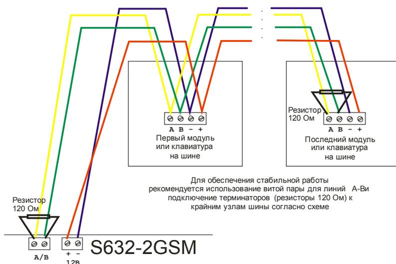
Рисунок 1 - Подключение устройств по шине RS-485
