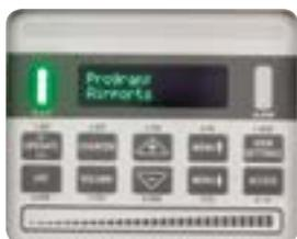
Благодаря интуитивному меню и удобному доступу к регулировкам с использованием слайдера прокрутки клавиатуры, настройка металлодетектора оператором чрезвычайно проста. 32-х символьный дисплей позволяет легко выполнить навигацию по меню (отсутствие запутанных кодов и аббревиатур для запоминания)
