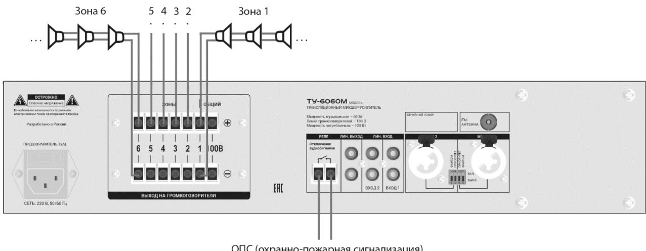
**8. Пример подключения громкоговорителей трансформаторного типа в режиме «ОБЩИЙ», в обход зональных регуляторов громкости.**
