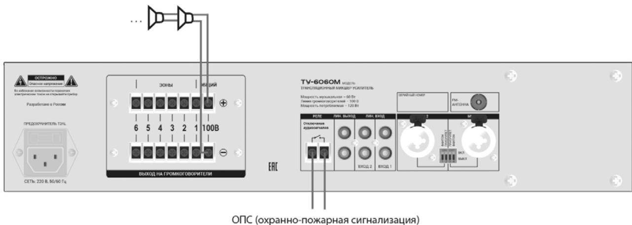
**9. Пример подключения периферийных устройств к усилителю серии «ТУ»**
