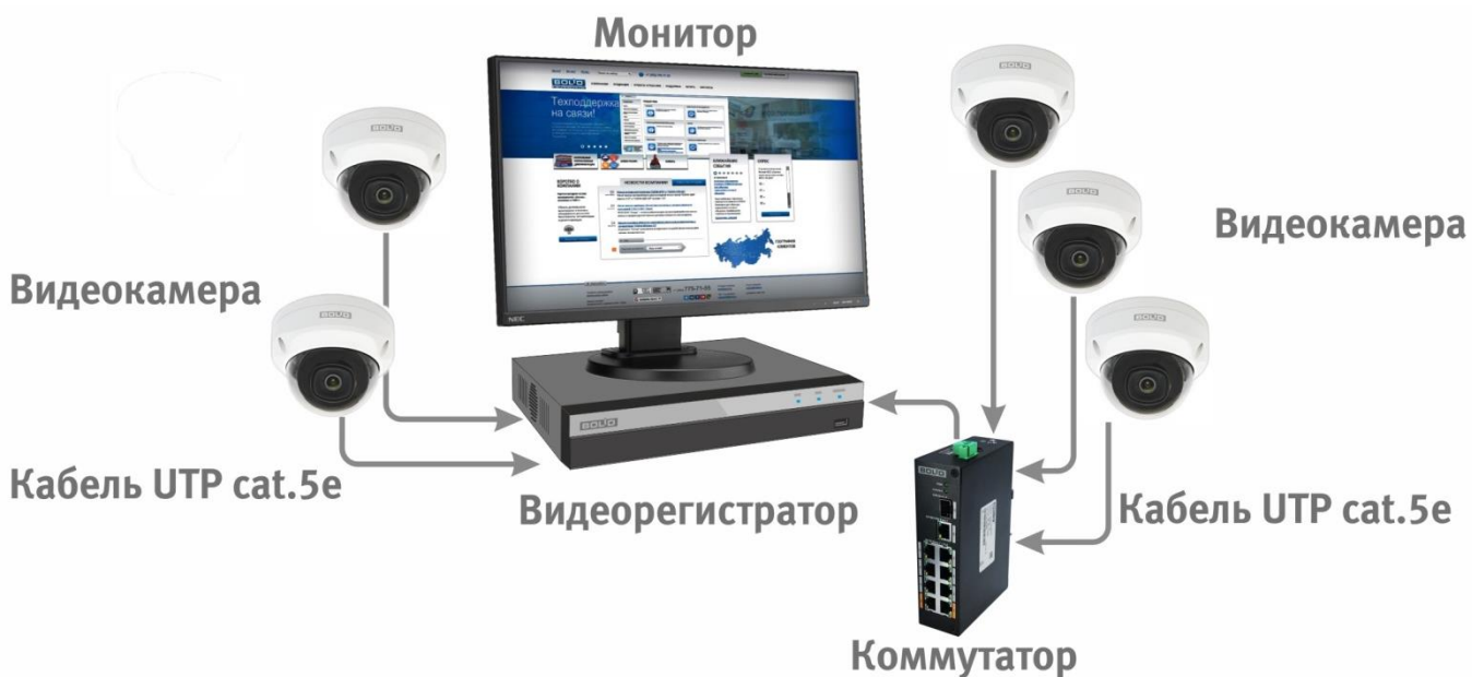
Рисунок 6.4 – Схема подключения видеокамеры к видеорегистратору
