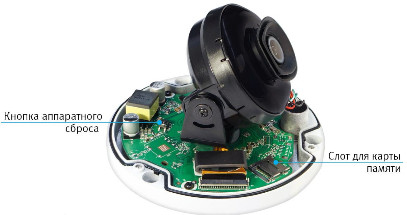
Рисунок 4.2 – Расположение кнопки аппаратного сброса и слота для карты памяти
