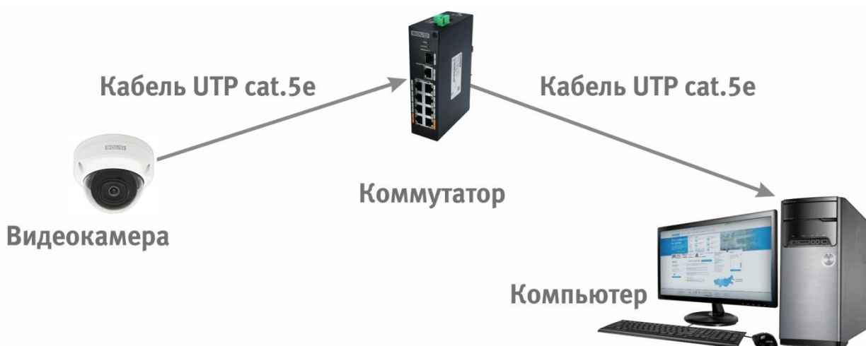
Рисунок 6.3 - Схема подключения видеокамеры к компьютеру через коммутатор
