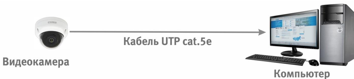
Рисунок 6.2 – Схема подключения видеокамеры к компьютеру
