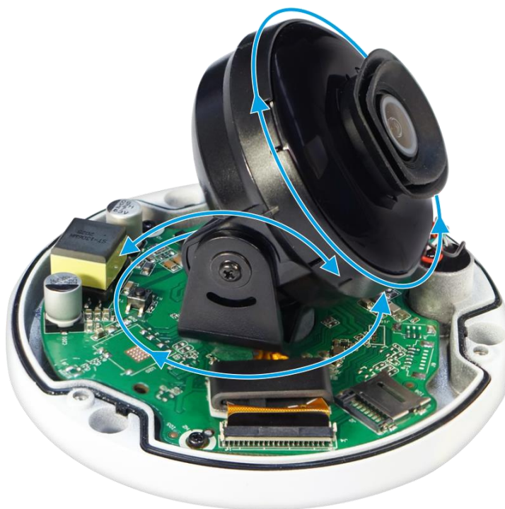
Рисунок 5.7 – Настройка направления объектива
