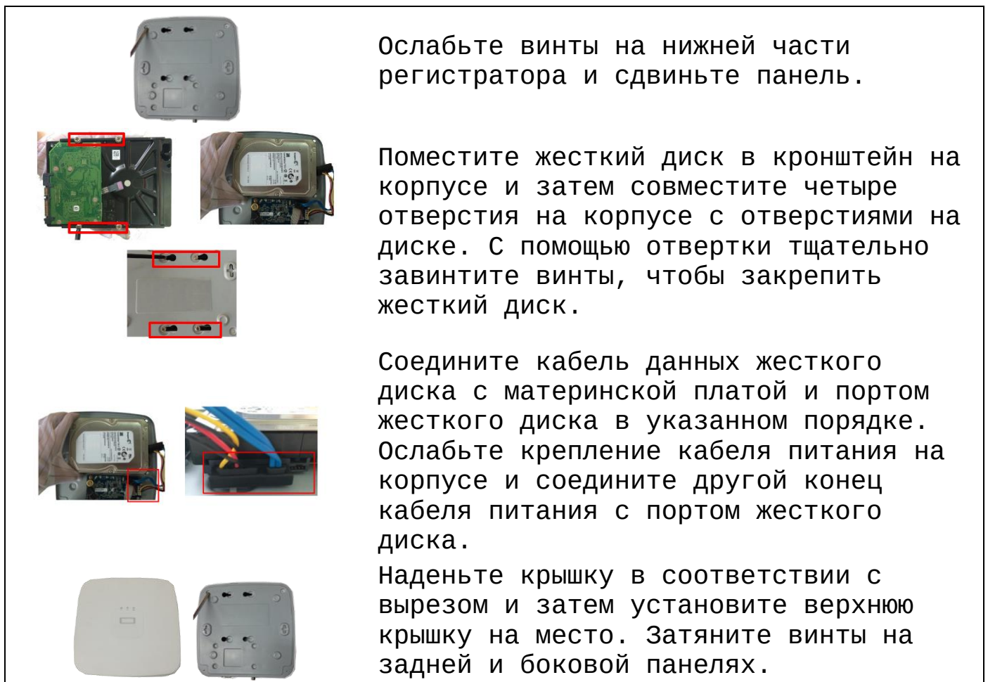
Рисунок 5.2 Порядок установки жесткого диска
