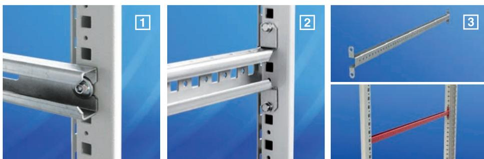
Предназначена для установки оборудования с бесступенчатой регулировкой: изоляторов; шинных сборок; кабелей. Крепится непосредственно к раме напольного распределительного шкафа, либо через держатель траверсы или монтажные рейки. Оборудование устанавливается на траверсы с помощью присоединительного комплекта IK 08 MG.
