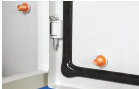
5. Надежное уплотнение достигается благодаря литой прокладке, наносимой роботом методом непрерывной отливки. Литая уплотнительная прокладка устойчива к температурам от -40 до +70 °С (полиуретан), от -60 до +135 °С (силикон).
