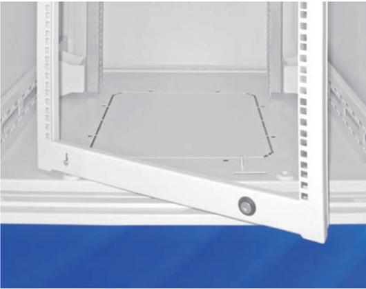
Для монтажа внутреннего оборудования 19" в напольных шкафах для сетевого и телекоммуникационного оборудования. Предназначена только для шкафов шириной 800 мм. Монтаж к каркасу. Регулировка установки по глубине. Блокировка 2 язычковыми замками с цилиндром. Право или левостороннее открывание
