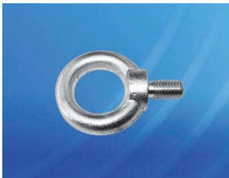
Предназначен для транспортировки напольных распределительных шкафов с помощью крана. Легко монтируется в резьбовые отверстия рамы взамен винтов для крепления потолочной панели, диаметр резьбы М12. Предельно допустимая статическая нагрузка 200 кг при транспортировке под углом 60°
