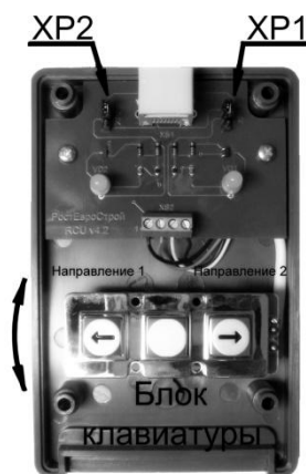
Вид пульта со снятой крышкой
