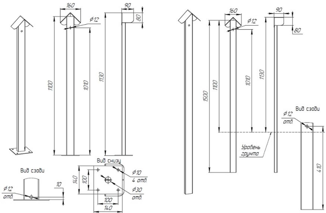
Исп. 00 (для монтажа на асфальт), 01 (под бетонирование)
