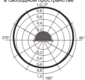
Рис.2 Схема подключения и диаграмма направленности оповещателя.
