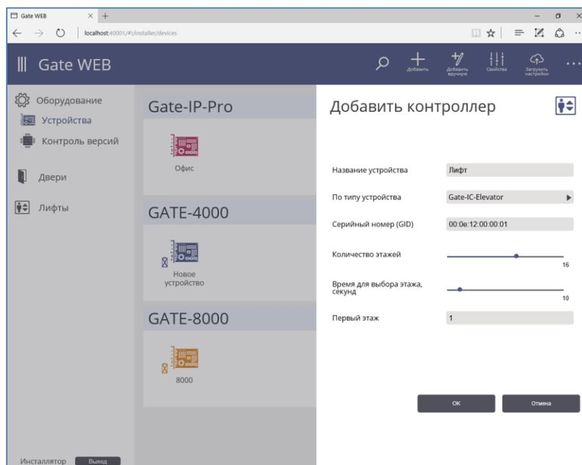
После добавления контроллера лифта точки доступа на этажи будут созданы автоматически.
