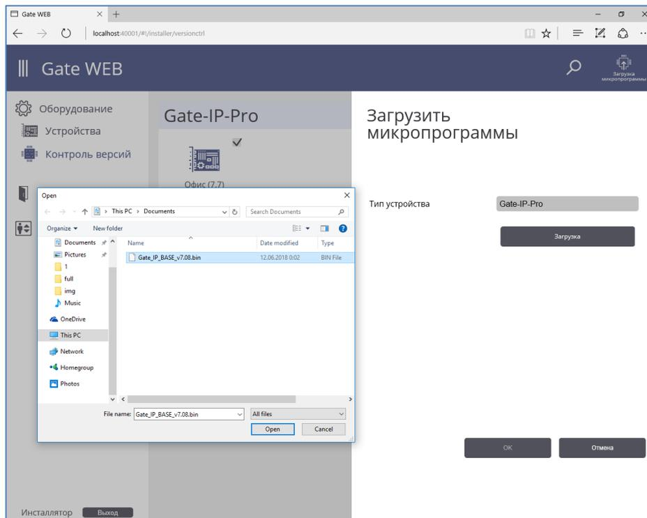
После нажатия кнопки "OK" будет выполнена загрузка микропрограммы в отмеченные контроллеры. Прогресс загрузки отображается под иконкой контроллера, в виде индикатора.
