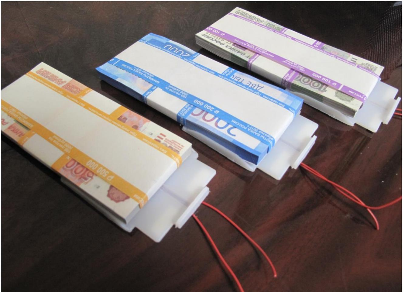
«КУКЛА-Л» - магнито - контактный извещатель в виде банковской пачки денег в 100 листов. Применяется в качестве датчика тревоги, размыкающего контакты в цепи тревожной сигнализации. Устанавливается в местах хранения денег (кассы, обменные пункты, квартиры и др.). Датчик рассчитан на подключение к центральному пульту охраны или к приборам охранной сигнализации, реагирующих на размыкание контактов.
