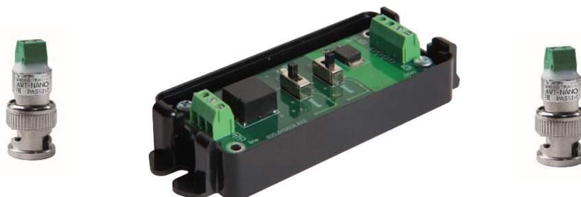
Впервые в состав комплекта входят три устройства: два пассивных и один активный приемопередатчик, и они способны реализовать три различных комбинации установки в зависимости от реальных условий на конкретном объекте.
