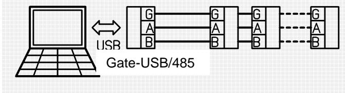
В линии допускается только последовательный способ подключения устройств «от одного к другому». При наличии ветвлений часть устройств в линии может не работать из-за несогласованности линии. Конечное устройство в линии дополняется резистором «терминатором» .
