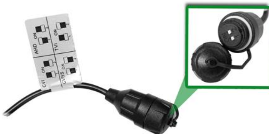
Рисунок 6.3 — Переключатель формата видеосигнала
