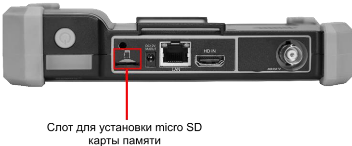
Рис. 21 Установка карты в Micro SD слот
