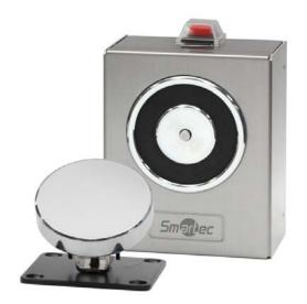
Электромагнитный фиксатор дверей ST-DH615U предназначен для удерживания дверей в открытом положении. Устройство используется в случаях, когда необходимо обеспечить свободное перемещение людей и техники. Кроме того, электромагнитный фиксатор можно подключить к системе пожарной сигнализации, и в случае возникновении пожара на объекте устройство разблокирует удерживаемую дверь и обеспечит герметизацию зоны. Кнопка отключения фиксации может использоваться для разблокировки двери вручную.
