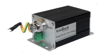
Грозозащита линии 12/24Вольт и коаксиального кабеля 75 Ом. Поддержка АНD до 5Мр и CVBS сигналов. Падение полезного сигнала не более 0,2дБ. Время срабатывания до 1нс, для клеммной колодки до 25нс. Максимальный ток разряда для клеммной колодки и разъема ВNC 10КА. Вес 180г, размеры 104х51х38мм. Металлический кожух IP20, от -20 до +50град, крепление на стену.
