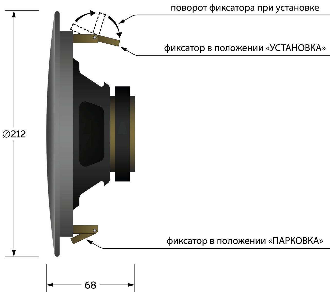
Рис. 2 Габаритные размеры и элементы крепления БА
