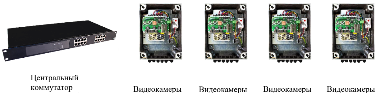
Рисунок 11. Подключение коммутаторов в топологию «линия»
