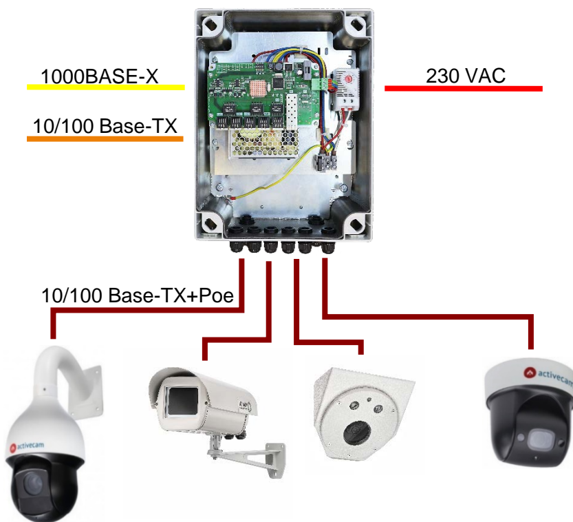
Рисунок 3. Типовая схема подключения коммутатора по медному кабелю и оптическому кабелю.
