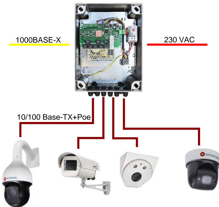
Рисунок 2. Типовые схемы подключения коммутаторов по оптическому кабелю.
