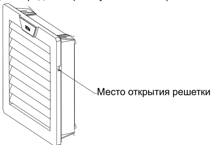
Рисунок 1. Внешний вид вентиляционной решетки
