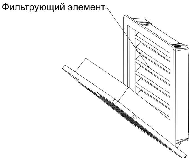
Рисунок 2. Порядок установки фильтрующего элемента
