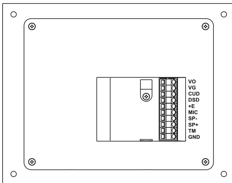
Рисунок 4 - Расположение клемм
