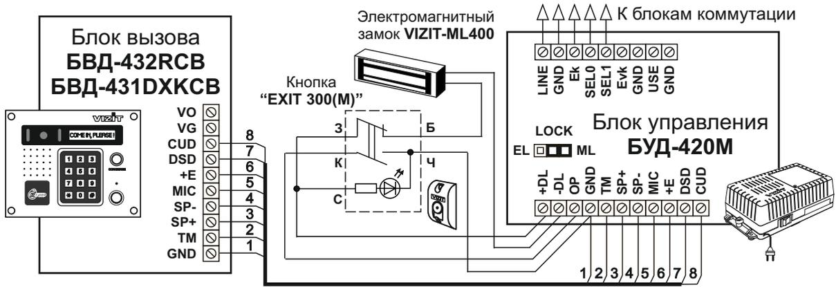
Рисунок 5 - Схема соединений блока вызова **БВД-432RCB**, **БВД-431DXKCB** с блоком управления **БУД-420М**, электромагнитным замком **VIZIT-ML400** и кнопкой “EXIT 300(М)”
