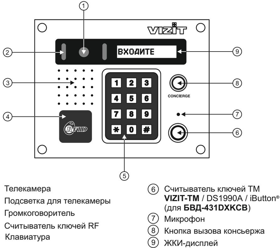
Рисунок 1 - Внешний вид и органы управления блока
