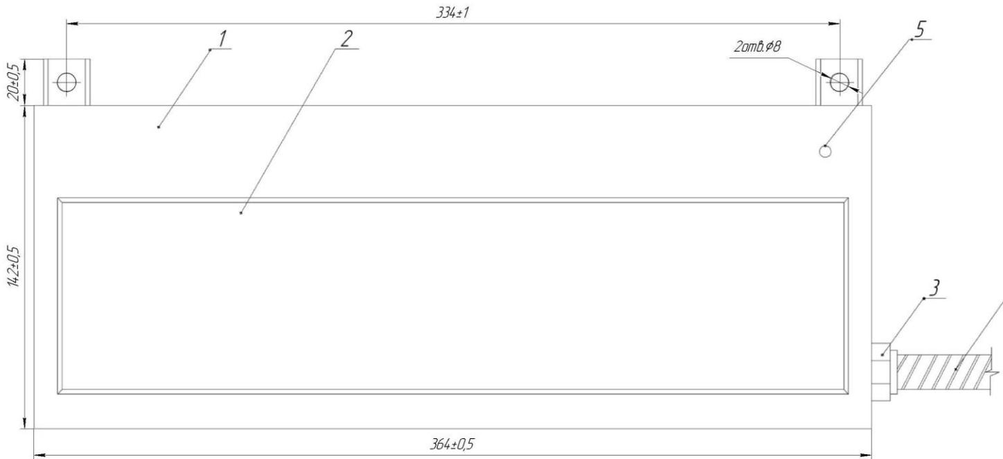
1 корпус; 2 прозрачное окно; 3 кабельный ввод; 4 кабель питания (постоянно присоединен); 5 индикатор «СЕТЬ»..
