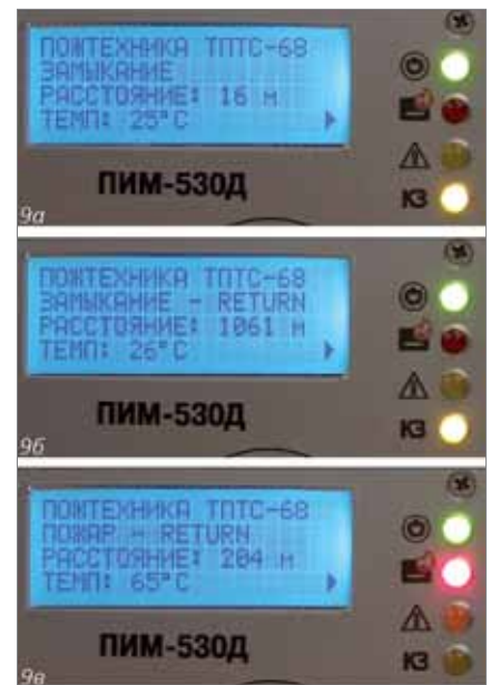
Рис. 9. Формирование сигнала «Пожар» при наличии короткого замыкания, кольцевое подключение
