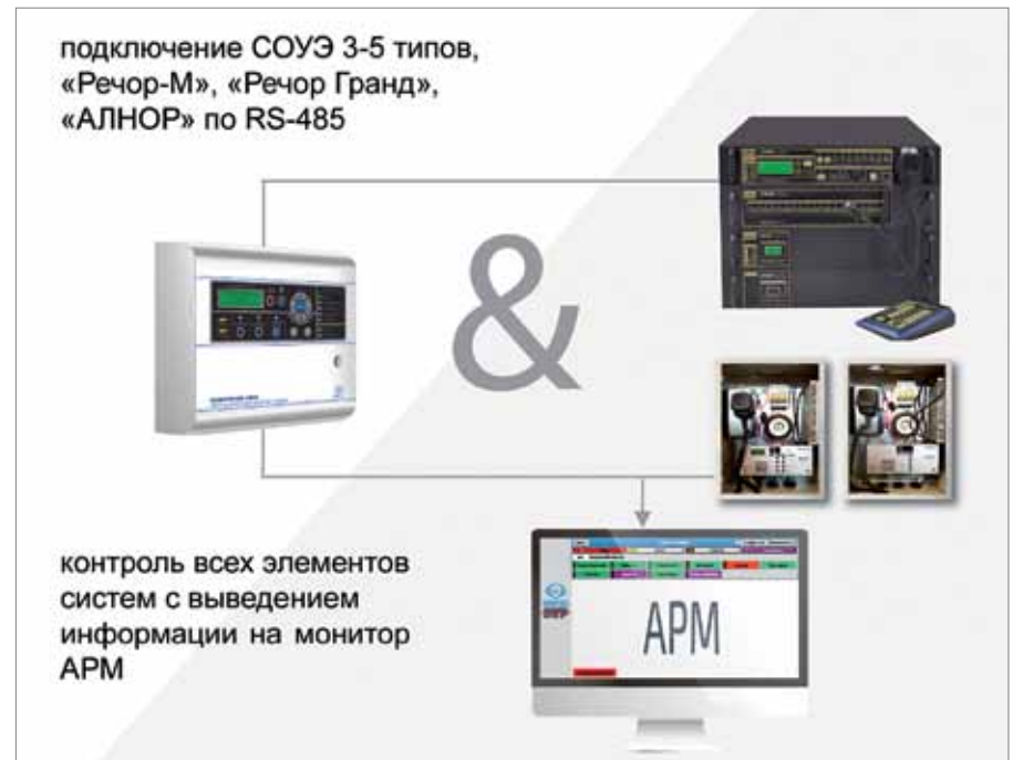
Рис. 1. Типовая схема интегрированной ОПС «АКОР»
