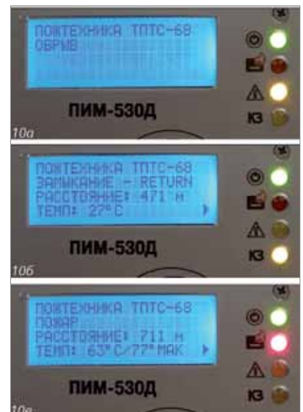
Рис. 10. Формирование сигнала «Пожар» при наличии обрыва и короткого замыкания, кольцевое подключение
