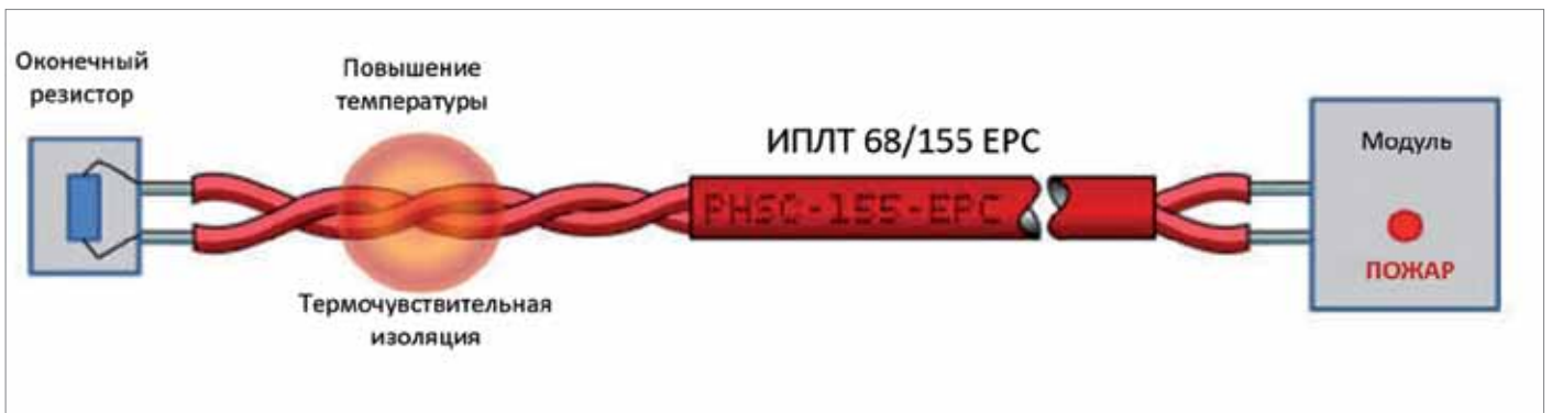
Рис. 2. Термокабель в режиме пожар
