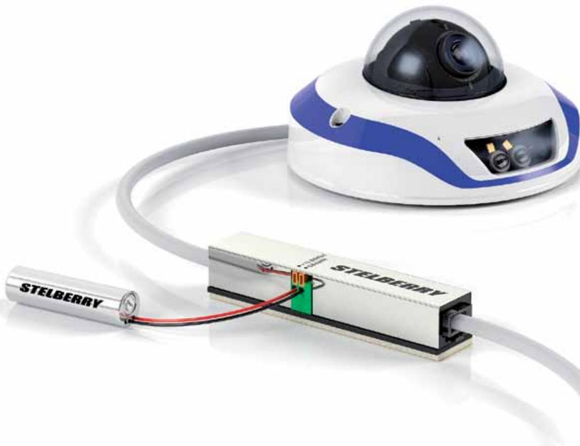
Прходной сплиттер MX-225 выполняет преобразование питания PoE 48 В, на высокой частоте, на уровне 1 МГц, в выходное постоянное напряжение +12 В. Качественная фильтрация выходного напряжения, позволяет использовать универсальный проходной сплиттер STELBERRY MX-225 для питания самых простых и бюджетных активных микрофонов, например, таких как М-10, М-20 и популярных дешевых микрофонов других производителей. Такие простые микрофоны обычно не имеют внутри себя собственных стабилизаторов напряжения.
