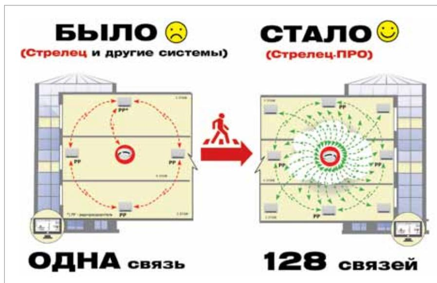
Рис. 1. «СТРЕЛЕЦ-ПРО»: Множество путей связи устройств с радиорасширителями
