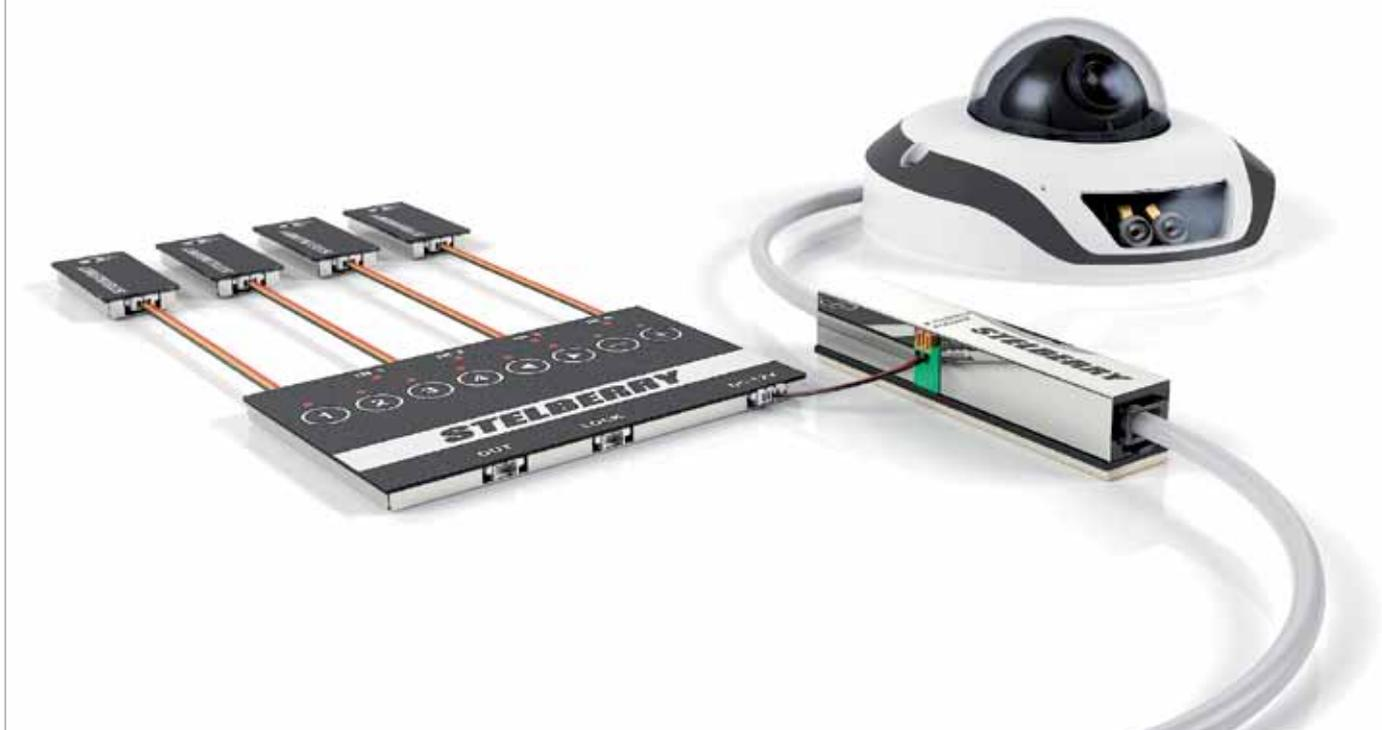
Проходной PoE-сплиттер STELBERRY MX-225 рассчитан на максимальный выходной ток до 200 мА, что позволяет с запасом запитывать от одного MX-225 сразу четыре микрофона М-70 и аудиомикшер MX-320. Причём питание от PoE-сплиттера ведётся только до микшера, а разветвление питания на все микрофоны производится уже в самом микшере.
