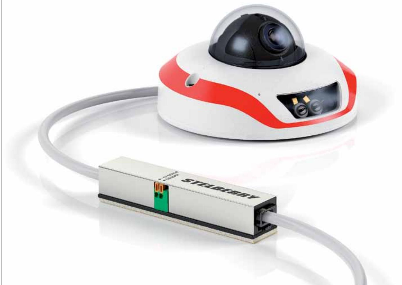
Проходной PoE-сплиттер STELBERRY MX-225 поддерживает формат PoE-питания, работающий по методу В: 802.3af и 802.3at, поэтому он хорошо совместим с таким оборудованием, которое передает и получает питание по 4-м выделенным проводам: положительное питание заводится на 4 и 5 контакты разъема RJ-45, а отрицательное питание заводится на контакты 7 и 8.
