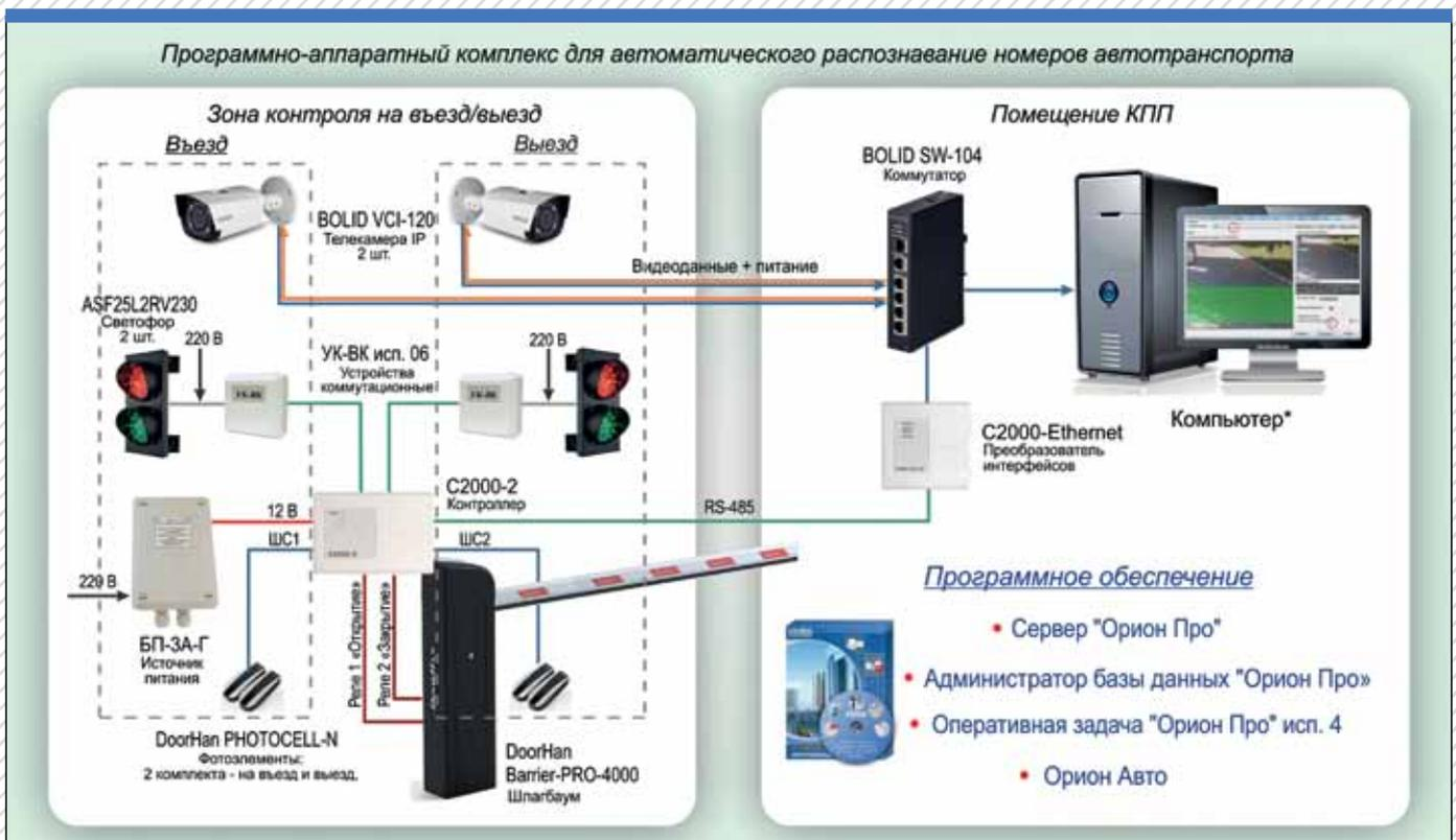
Рис. 1. Схема построения системы видеонаблюдения с автоматическим распознаванием автономеров при въезде (выезде) на охраняемую территорию
